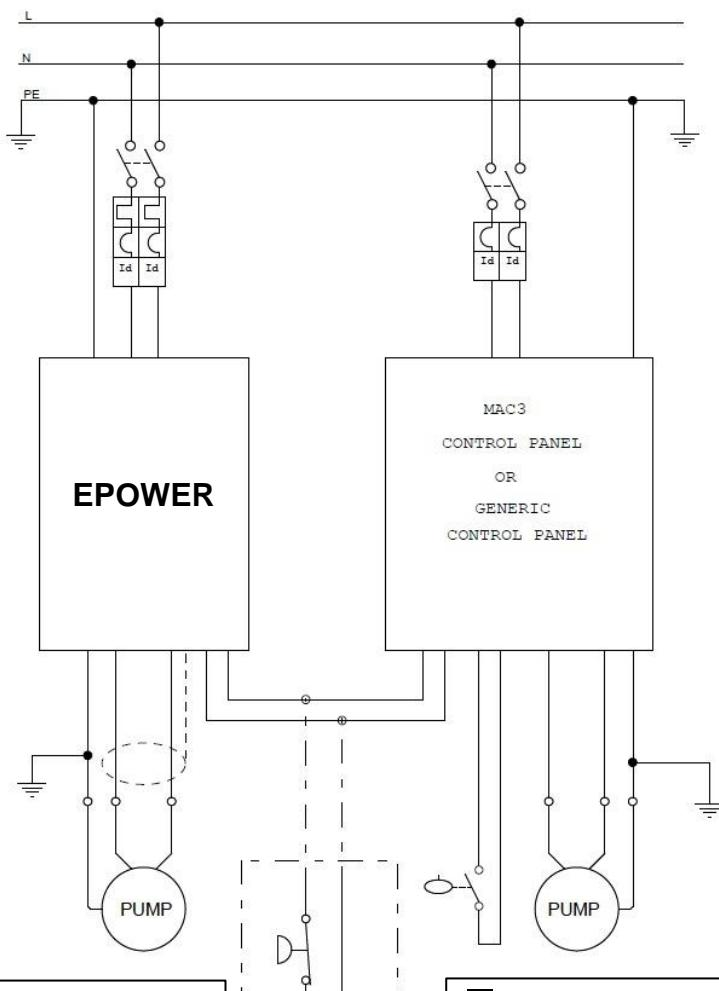
**ES** En caso de mantenimiento del Variador se puede conectar un presostato auxiliar que permite garantizar la continuidad del servicio en el sistema con la segunda bomba.
