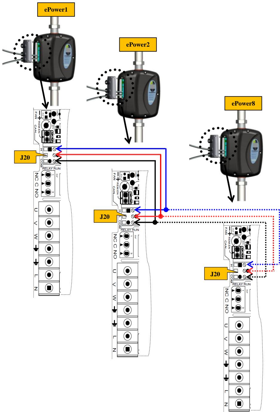
N.B. Es posible utilizar sólo un flotador para controlar el grupo en el modo multibombas:
