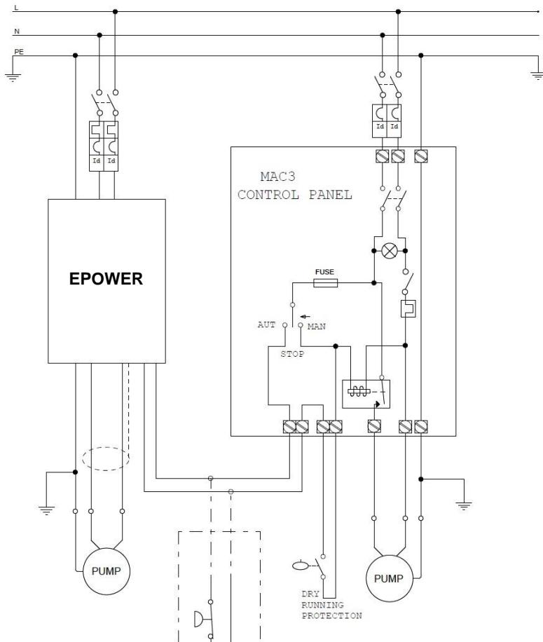
**ES** En caso de mantenimiento del Variador se puede conectar un presostato auxiliar que permite garantizar la continuidad del servicio en el sistema con la segunda bomba.
