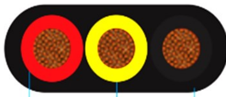
Aislamiento de PVC de núcleos (Rojo, amarillo, negro). Conductor de cobre flexible. Funda de PVC (Negro)
