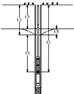
**L1:** profundidad de instalación mínima por debajo del nivel dinámico del agua. Se recomienda un mínimo de 1 metro.
