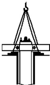
3. Levante la parte de la bomba por medio de abrazaderas de tubo instaladas en la tubería de extensión, vea la fig. 3.
