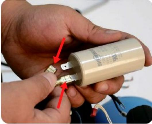
7. Retire la conexión del condensador.
