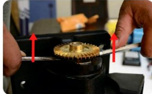
14. Con un destornillador de cabeza plana para levantar el impulsor.
