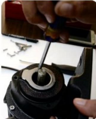
21. Utilice un destornillador de cabeza plana para levantar la parte estacionaria del sello mecánico.
