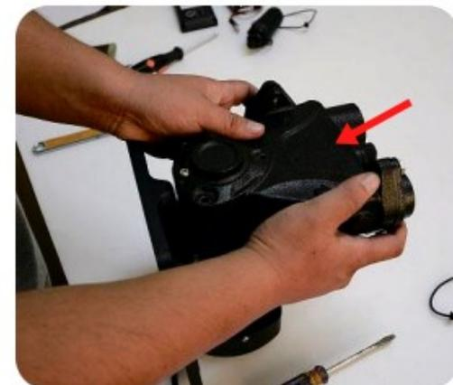
11. Montaje del cárter de la bomba con moto.
