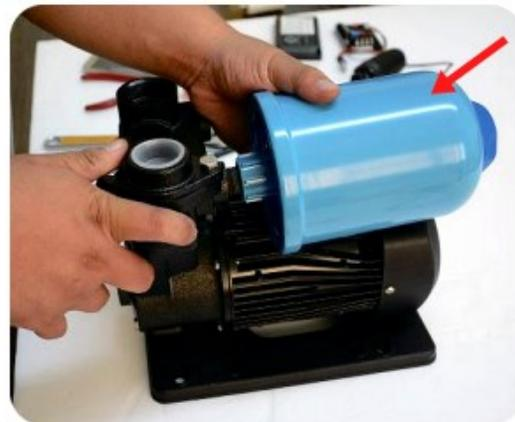
13. Instale el tanque de la bomba.
