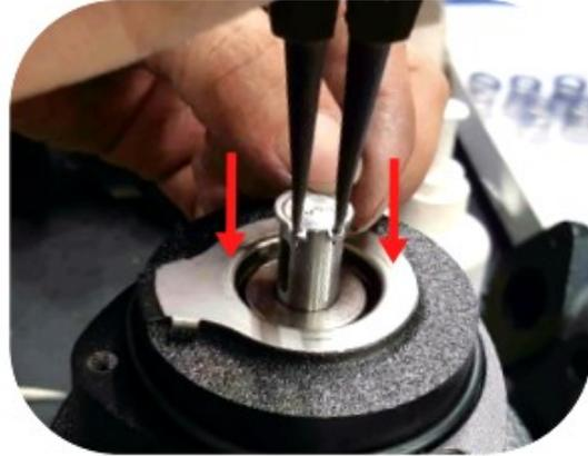
8. Usando pinzas de punta larga para instalar el anillo tipo C.
