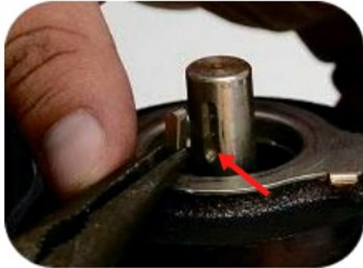
9. Coloque la llave paralela en el eje.
