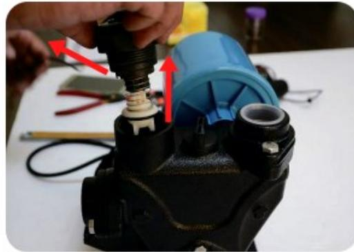
10. Usar una llave para retirar el interruptor de flujo / válvula de retención.
