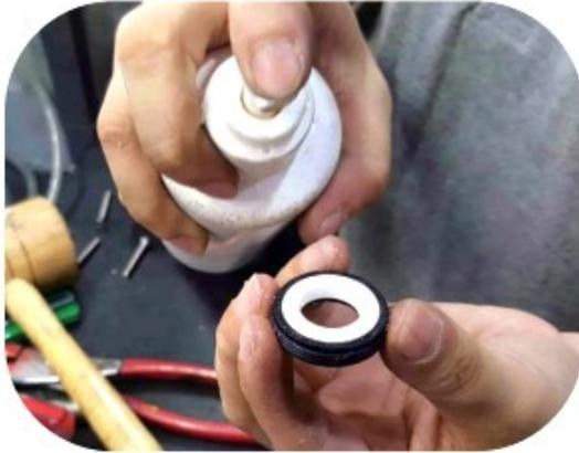
1. Rocíe agua sobre la parte estacionaria para lubricación.
