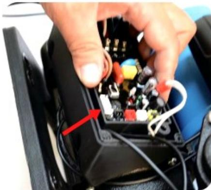
19. Vuelva a colocar la caja de control en la caja de cableado.
