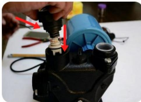
14. Instale el interruptor de flujo / válvula de retención y use una llave para apretar.
