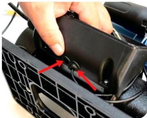
16. Instale los cables de conexión del interruptor de presión y el interruptor de flujo / válvula de retención.
