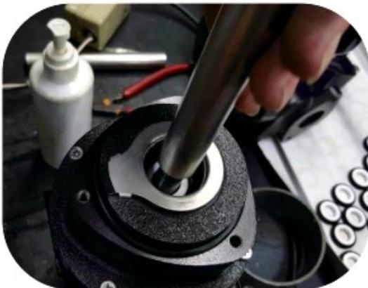
3. Usando la herramienta, empuje la parte estacionaria a la posición inferior.
