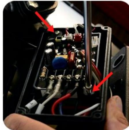
2. Retire los tornillos tipo Phillips x 2 del tablero de control.
