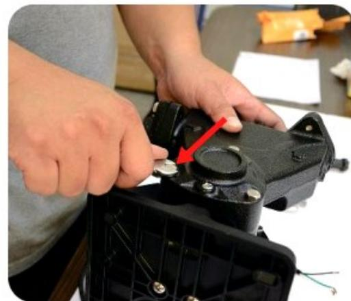
12. Retire el perno hexagonal x 3 de la carcasa de la bomba.
