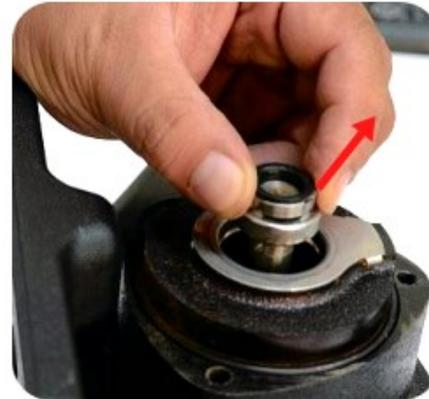
20. Retire la parte giratoria del cierre mecánico.
