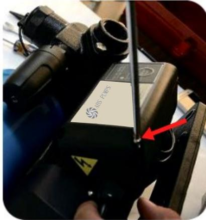
1. Quite los tornillos tipo Phillips x 4 y saque la cubierta de la caja de cableado.
