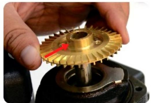
10. Coloque el impulsor en el eje y haga que el impulsor gire libremente.
