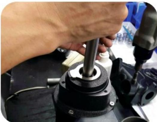
5. Usando la herramienta instale la pieza giratoria.
