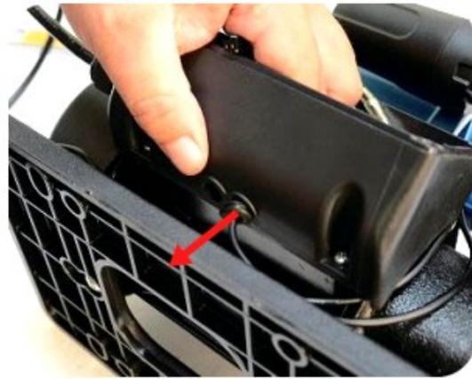
8. Extraiga los cables de conexión del interruptor de presión y el interruptor de flujo / válvula de presión y el interruptor de retención.
